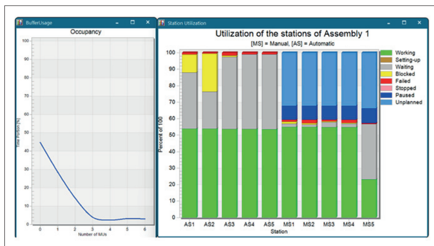
Obr. 2. Míra zaplnění přidaného meziskladu (vlevo) a využití pracovišť (vpravo)
